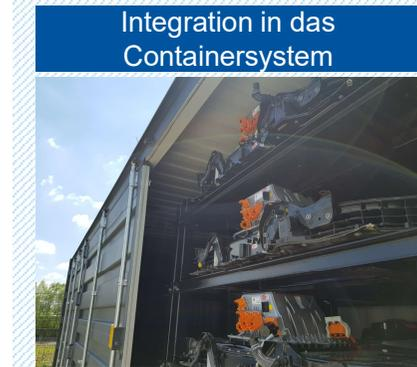
Vereinfacht besteht ein stationäres Speichersystem aus Batteriespeichern, Leistungselektronik sowie benötigter Peripherie. Zur Peripherie gehören Steuerungs-, Kühl- und Spannungsversorgungskomponenten.
